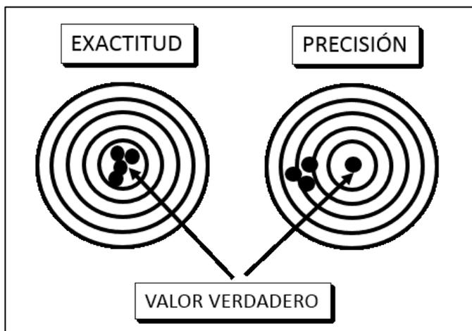
Figura 1 - Diferencia entre exactitud y precisión
