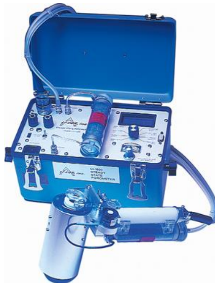
Figura 3: Equipo de medición de conductancia estomática Licor 1600
