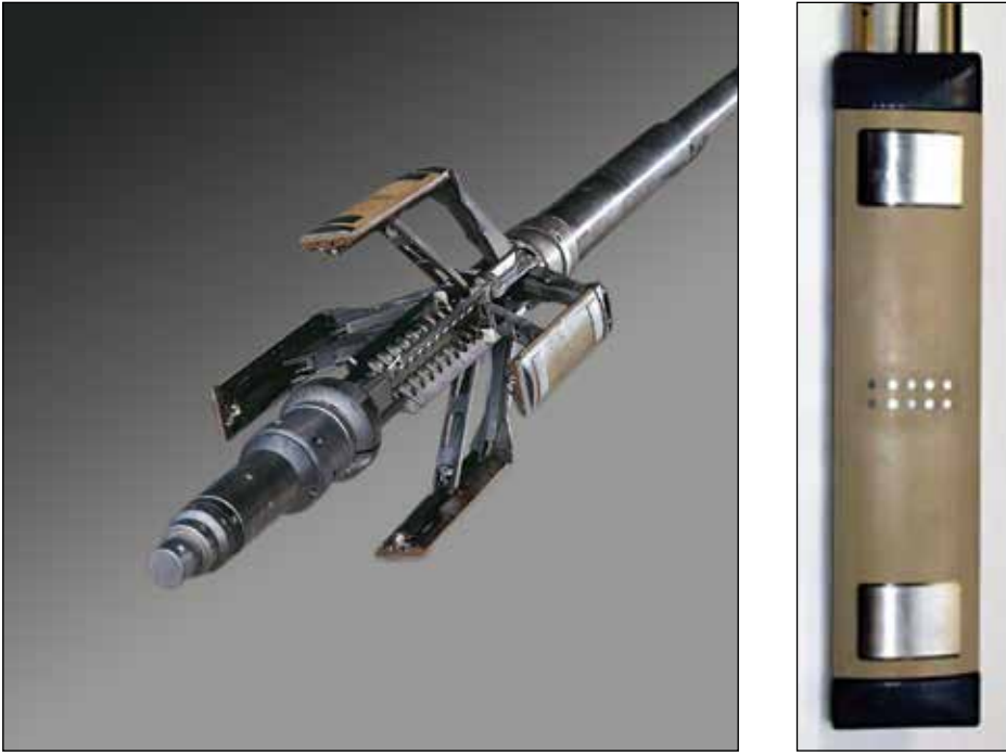
Figura 16. Sonda y patín del servicio OBMI. La herramienta OBMI (izquierda) posee cuatro patines. Cada patín (derecha) cuenta con dos hileras de botones sensores. La corriente es emitida desde los sensores y retorna a los electrodos emplazados por encima y por debajo de los sensores. Dada la cobertura limitada del pozo que ofrece este diseño, se desarrolló la herramienta OBMI2, que consiste en dos herramientas apiladas y separadas por un ángulo de 45° (no mostrada).
