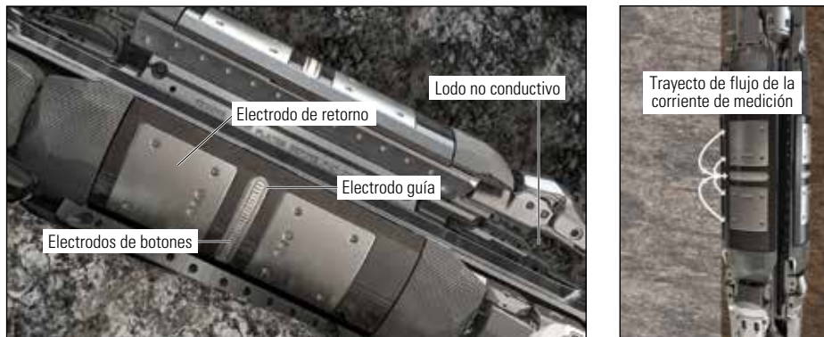
Figura 18. Diseño del patín Quanta Geo. Cada uno de los ocho patines idénticos para el servicio Quanta Geo posee una hilera de electrodos de botones rodeados por un electrodo guía (izquierda). Los electrodos de retorno se sitúan por encima y por debajo de los electrodos de botones. Dos corrientes alternas (CA) de alta frecuencia son forzadas a fluir a través del lodo y el revoque de filtración hacia la formación; las corrientes (derecha, flechas blancas) retornan a los electrodos superiores e inferiores, proporcionando una respuesta simétrica. El electrodo guía impide que la corriente retorne directamente a la herramienta. La corriente que fluye desde cada uno de los botones se mide y se computa la impedancia. Esta impedancia contiene tanto la relación de amplitud entre el voltaje y la corriente como el corrimiento de fase para las dos frecuencias de la CA. El diseño de la herramienta proporciona una resolución vertical de 6 mm [0,24 pulgadas] y una resolución horizontal de 3 mm [0,12 pulgadas].
