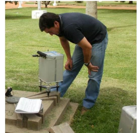
Figura 4.6: Gravímetro Scintrex™ Autograv CG-5
