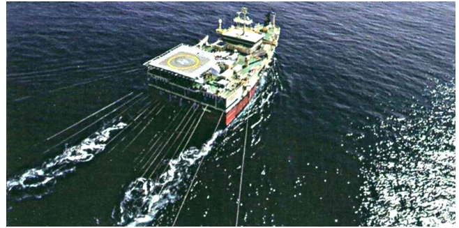
Nave sísmográfica en el mar del Norte (foto Hart's E&P)
