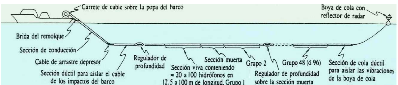
Esquema de barco sismográfico arrastrando una línea de grupos de hidrófonos (modificado de Sheriff & Geldart, 1991)
