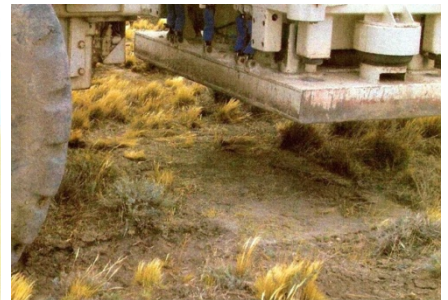
Chubut, vibros a campo travesía e impronta de la plancha en el suelo luego de la emisión (fotos Unión Geofísica Argentina)
