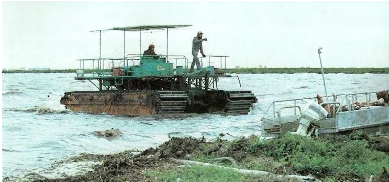
Vehículo a oruga anfibio en una zona pantanosa llevando los cables y ristras de los geófonos (fotos Compagnie Générale Géophysique)
