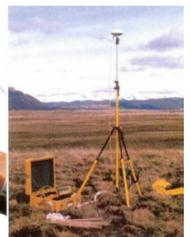
Teodolito electrónico, GPS y reflector para el relevamiento topográfico (fotografías Compagnie Générale Géophysique)
