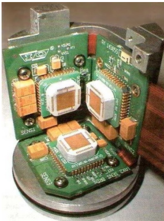
Interior de un geófono triaxial (fotos Compagnie Générale Géophysique)
