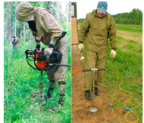
Izquierda, perforación; derecha, pulsador en posición para el golpe (fotos geodevice.com)
