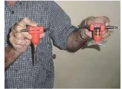
Geófonos con punta y con base plana (foto Geofísica Exploración YPF)
