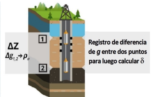
Herramienta de pozo que contiene el gravímetro MEMS Silicon MicroGravity
