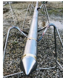
Herramienta de pozo que contiene el gravímetro MEMS Silicon MicroGravity
