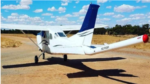
Magnetómetro de precisión instalado en la cola de un avión en Western Australia (foto Frontier Resources)
