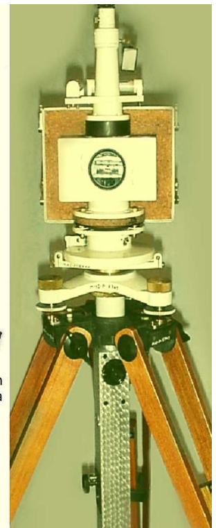
Balanza magnética de Schmidt (modificado de Griffiths & King, 1972)
