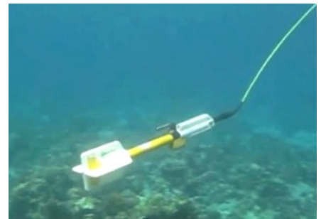
Prospección subácea con un magnetómetro de vapor de cesio Geomatrix 882 sumergible (foto Arqueonautas)
