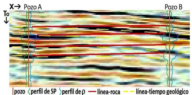
Sección sísmica con perfiles de pozos donde se indica la diferencia entre línea-roca y línea-tiempo; ver texto.
