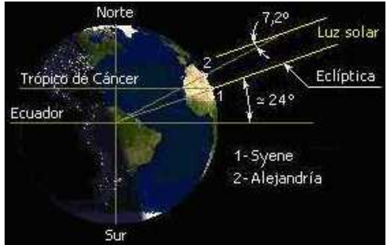
Concepto del cálculo hecho por Eratóstenes; ver texto (gráfico de Magister Mathematicae)
