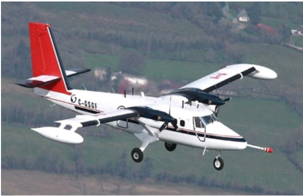
Avión en prospección EM; las bobinas pueden ser instaladas en la nariz, la cola o los extremos de las alas (foto Éireann Suirbhéireacht Gheolaíochta)
