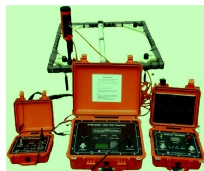
Equipo para adquisición EM en el dominio del tiempo (foto cqtopgeo.com; China)
