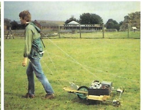
Caso de configuración móvil polo-polo para bajo presupuesto...
