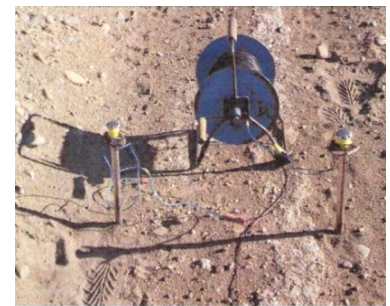
Adquisición geoelectrica con corriente continua (modificado de Robinson & Corugh, 1988)
