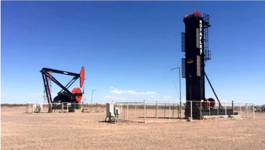
Aparejos de producción: tradicional "cigüeña" a la izquierda, y reciente "jirafa" a la derecha; yacimiento Loma Campana, cuenca Neuquina, con producción de petróleo no convencional desde las lutitas de la Formación Vaca Muerta (foto Adriano Calalesina)
