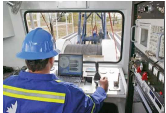
Operador del malacate en el camión de perfilaje. (foto Century WL Services)
