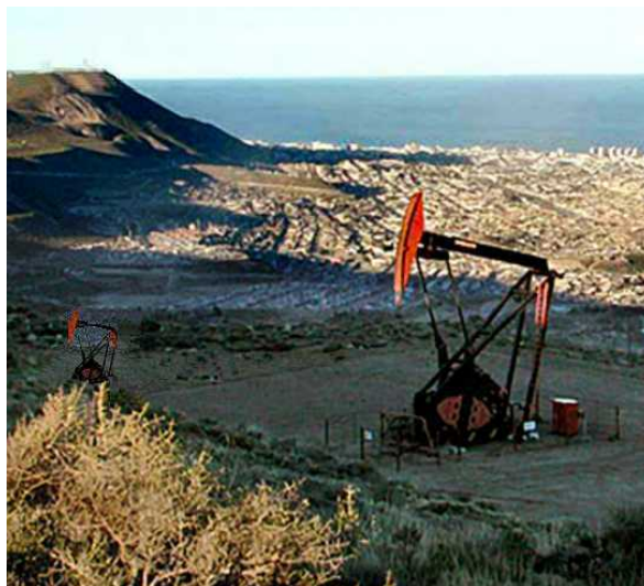
Cigüeñas de bombeo de petróleo en pozos de Comodoro Rivadavia (foto Diario El Patagónico)
