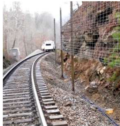
Los geófonos del arreglo 2 están en la zanja adyacente a las vías a la derecha y la caja electrónica a la izquierda. Microsísmica en seguridad ferroviaria (modificado de Collins et al. , 2014)
