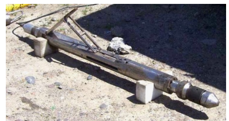
Herramienta de geófono triaxial de Baker Hughes fuera del pozo; obsérvese el brazo para empujar contra un lado y pegar la herramienta en el opuesto (foto L. Chelotti)
