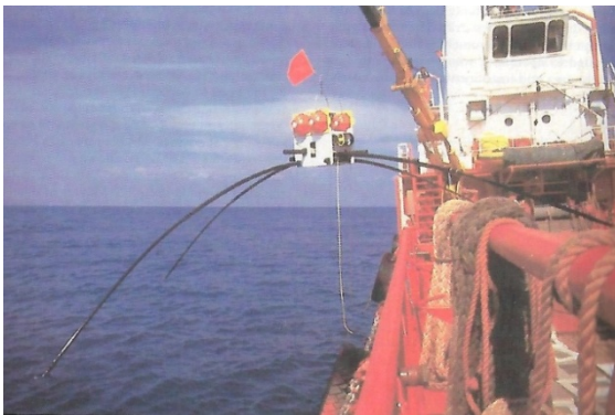
Instrumento magnetotelúrico listo para ser bajado al fondo marino y abajo perfiles resultantes sobre un domo salino (modific. de Constable et al. , 1998 a,b)
