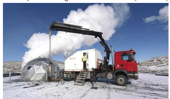
Perfilaje en un pozo de producción geotermal en Islandia (foto ÍSOR)
