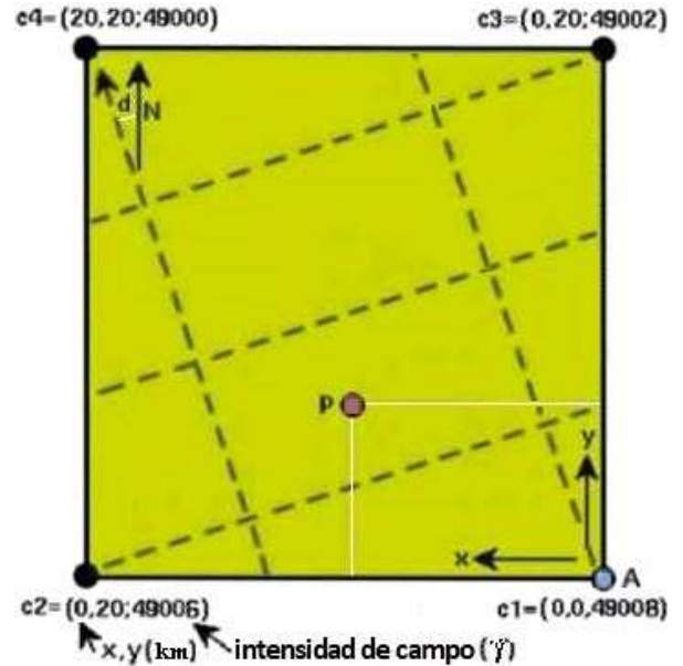
Esquema de corrección latitud-longitud para el hemisferio sur: las líneas de trazos indican tres paralelos y dos meridianos geomagnéticos, d es el ángulo de declinación, A es la base de referencia y P un punto de estación al que, para corregir, deben sumársele 2 \gamma por el cambio de latitud y 1 \gamma por el cambio de longitud, es decir 3 \gamma en total.
