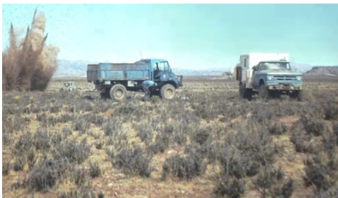
Sísmica de refracción con explosivos. Izquierda, Puna jujeña, 1985, detonación superficial (foto L. Chelotti) Derecha, tiempo actual con una carga reducida y optimizada en un pocito de 1 m. (foto Geoconsultores)
