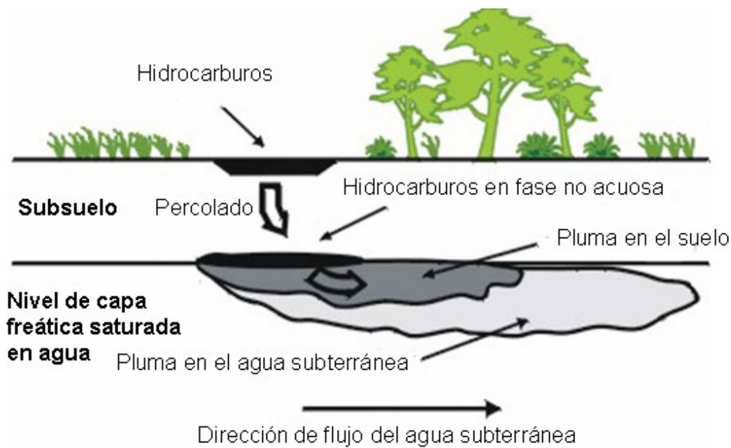
Figura 5. Típica pluma de hidrocarburos. El hidrocarburo percola a través del suelo, y se acumula sobre el agua subterránea, ya que flota sobre ella.
