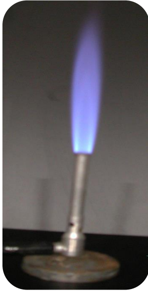
Fig. 1 a - Llama correcta para el trabajo en microbiología
