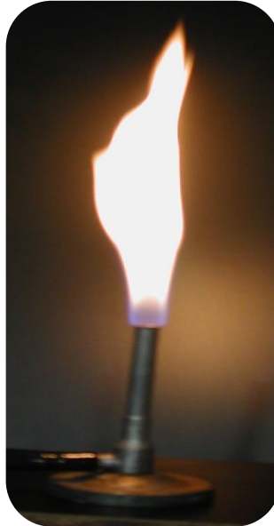
Fig. 1 b - Llama fría, incorrecta para el trabajo en microbiología
