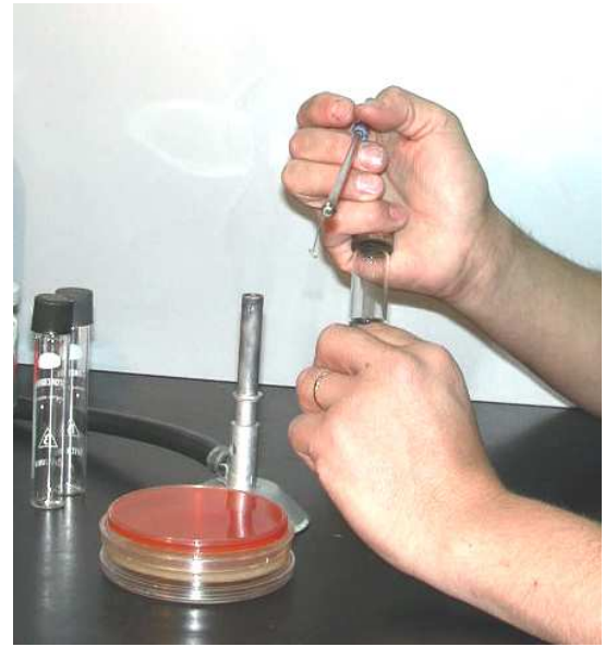
Fig. 2b: Trabajo en forma estéril, a no mas de 15 cm del mechero. Transferencia desde un cultivo líquido.
