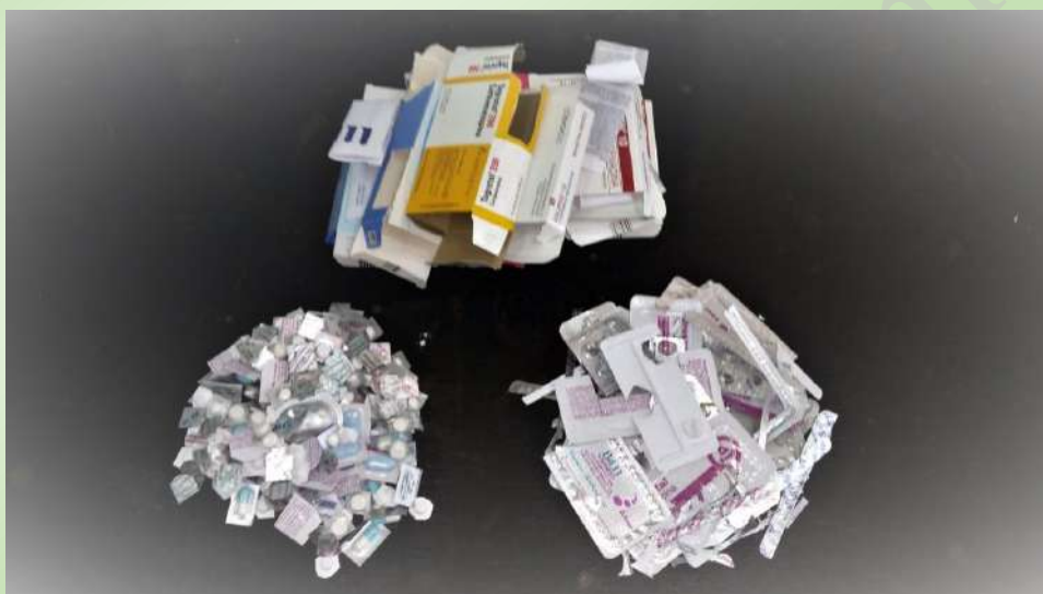
Figura 1. Cajas y prospectos, medicamentos y partes de blisters sin medicamento por separado. Como se observa abajo a la izquierda quedan las unidades de medicamento con su envase primario conservado que serán incorporadas junto con la mezcla cementicia en las botellas plásticas.
