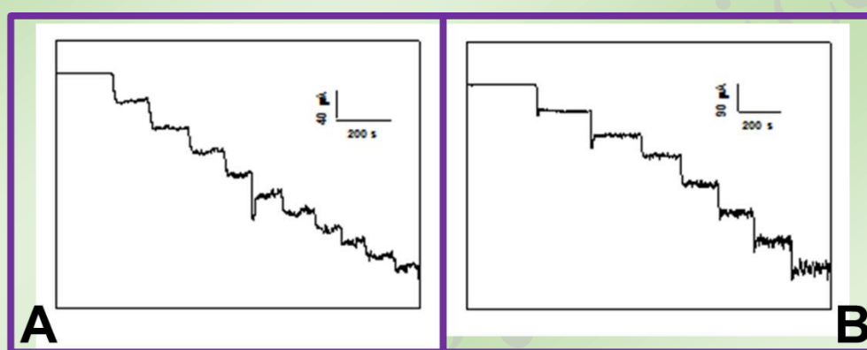
Figura 4: Registros amperométricos obtenidos a partir de experimentos realizados por adiciones sucesivas de (A) 0,5 mM y (B) 1,0 mM Cr (VI) a -430 mV. Electrolito soporte: \text{H}_2\text{SO}_4 pH: 1,0. Electrodo de referencia: Ag/AgCl. Contraelectrodo: Platino.
