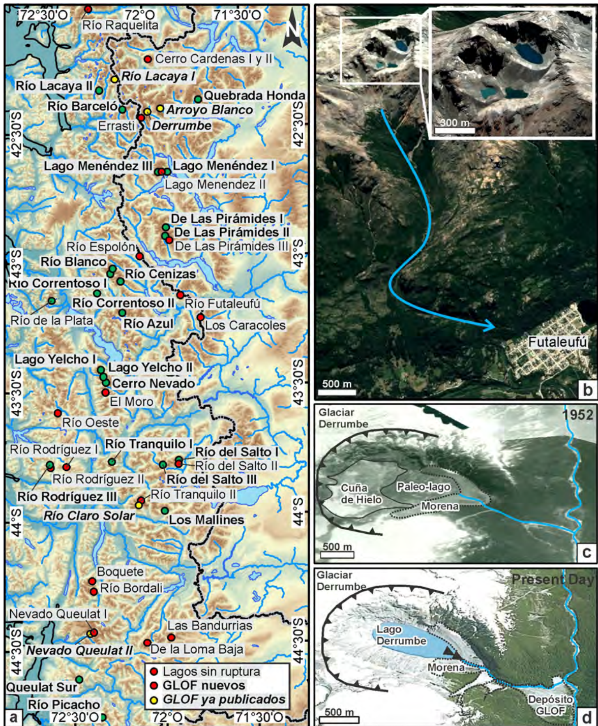
Figura 1. a) Localización de los lagos glaciares sin ruptura y con ruptura de dique morénico (nuevos y publicados previamente). b) Cuerpos lacustres endicados por morenas aguas arriba de la localidad chilena de Futaleufú. c y d) Geomorfología de la Laguna Derrumbe pre y post ruptura del dique morénico entre los años 1952 y 1964.
