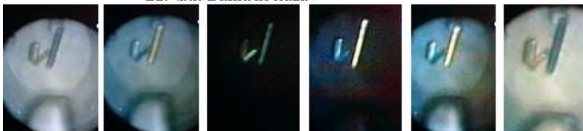
Observados con un polkroid y un analizador, los cristales obtenidos, se puede constatar que algunos rotan el plano de polarización de la luz a la derecha y otros lo hacen a la izquierda. Por ello la solución no evidencia actividad óptica cuando se la analiza con el polarímetro
